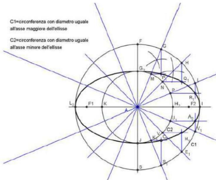
Figura 18: Costruzione dell'ellisse con centri concentrici ([https://www.lascienzadeldisegno.it/disegno\\_geometrico\\_28.html](https://www.lascienzadeldisegno.it/disegno_geometrico_28.html))
