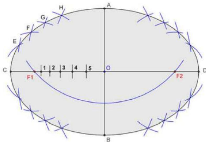
Figura 17: Costruzione di un'ellisse dati gli assi
