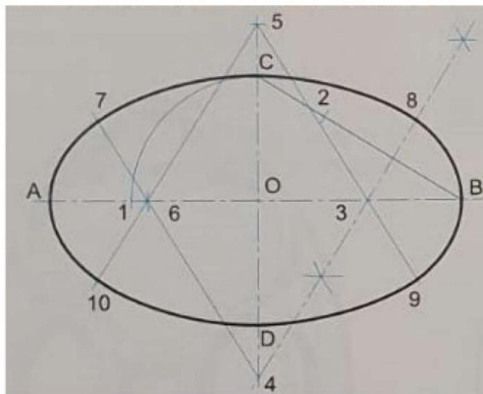
Figura 25: Costruzione dell'ovale noti i due assi  $AB$  e  $CD$  (Dallavecchia, 2014, p. 104)
