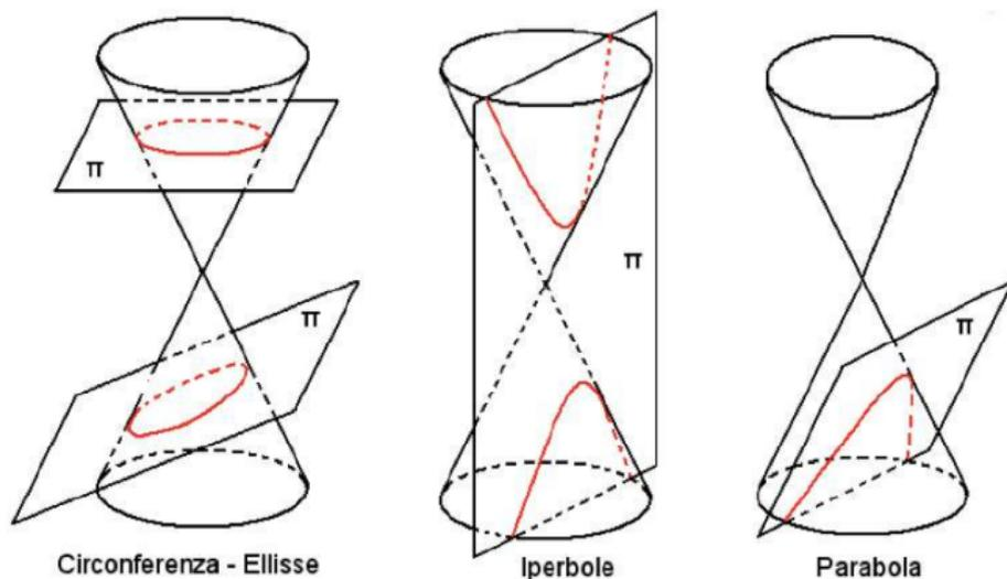
Figura 13: Cono a doppia falda e coniche (<https://www.competenzamatematica.it/2018/01/22/le-sezioni-coniche-e-la-figura-di-ipazia/>)
