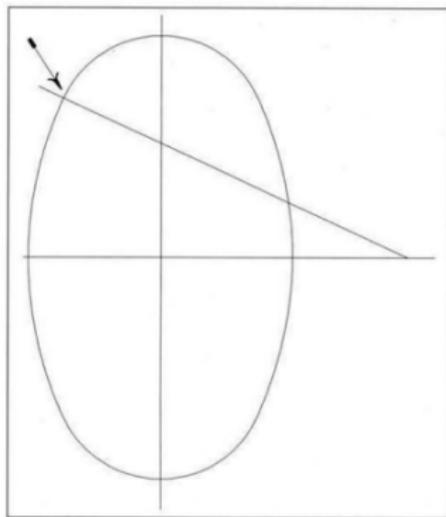
Figura 9: L'ovale appare schiacciato nel punto in cui si saldano due archi di diverso raggio (Migliari, 1995, p. 95)
