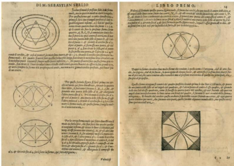
Figura 20: Le quattro costruzioni geometriche dell'ovale nel Trattato di Architettura di Sebastiano Serlio (Tutte l'Opere d'Architettura di Sebastiano Serlio Bolognese[...], Primo Libro, 1584, pag. 13-14)
