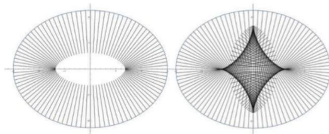
Figura 31: Le rette normali ad una ellisse non si incontrano in un unico punto e la curva che definisce l'inviluppo è detta evoluta, immagini realizzate con il software Mathematica da Corrado Falconi (Carlini e Magrone, 2017, p. 300)
